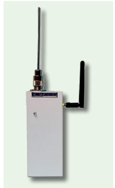
Объектовый прибор – VHF передатчик с дублированием по GSM
