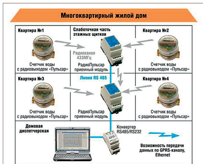
Рис. 2. Схема организации энергоучета в многоквартирном жилом доме
