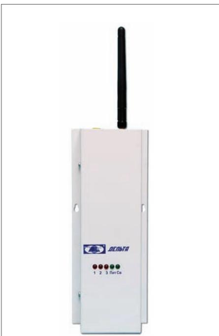
Рис. 8. Объектовый прибор-передатчик ISM-диапазона (868 МГц)
