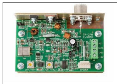
Рис. 5. CB-передатчик
