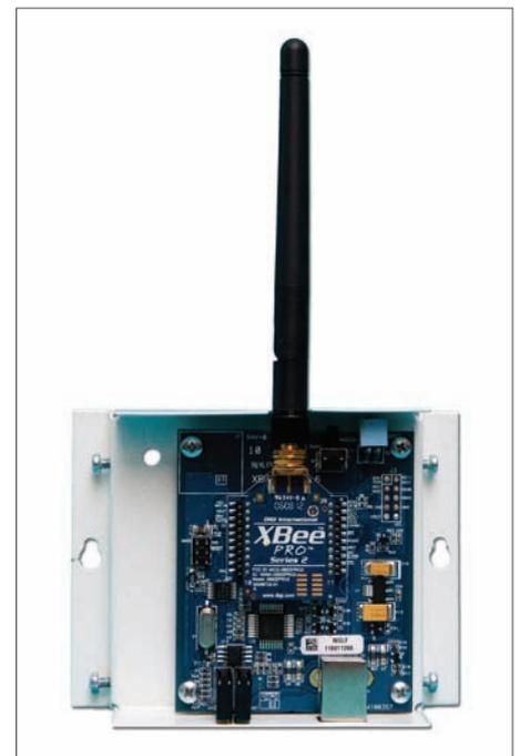
Рис. 7. Базовый приемник ZigBee
