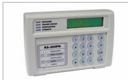
Рис. 6. Пульт управления базовой станции ISM-диапазона (433,92 МГц)
