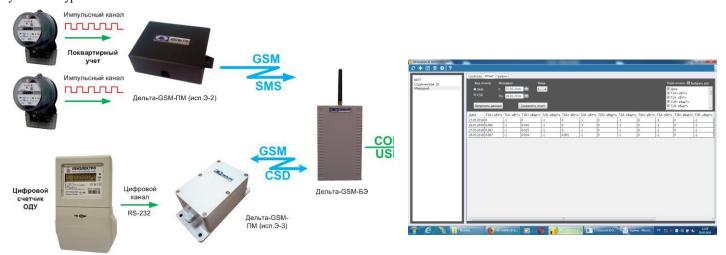
«Дельта-GSM-ПМ» (исп. Э-3) GSM модем с передачей по GPRS, CSD и SMS с интерфейсом RS-232. Встроенный блок питания от сети 100-240В. Встроенная антенна с возможностью подключения выносной. Герметичный корпус, из ударопрочного пластика АБС с классом защиты - IP65, обеспечивает применения в условиях повышенной влажности и пыли.
